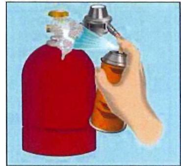
*Bild 5 Dichtheitsprüfung der Anschlussverbindung*
